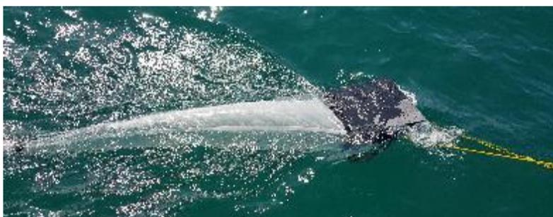
Gambar 15: Panel persegi hitam besar berada di sisi atas jaring saat pengambilan sampel.
